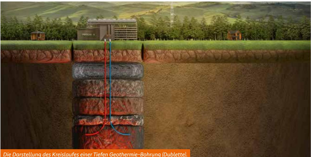
Die Darstellung des Kreislaufes einer tiefen Geothermie-Bohrung (Dublette).
